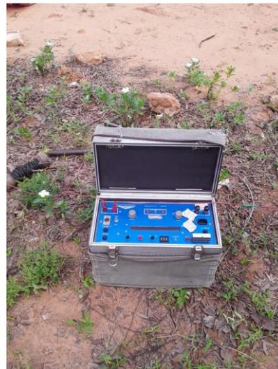
**Auch neues Gerät wurde bei Untersuchung der Bodenschichten eingesetzt (hier: Geotron Resistivity Meter Model G-41 of Geotron Systems)**
